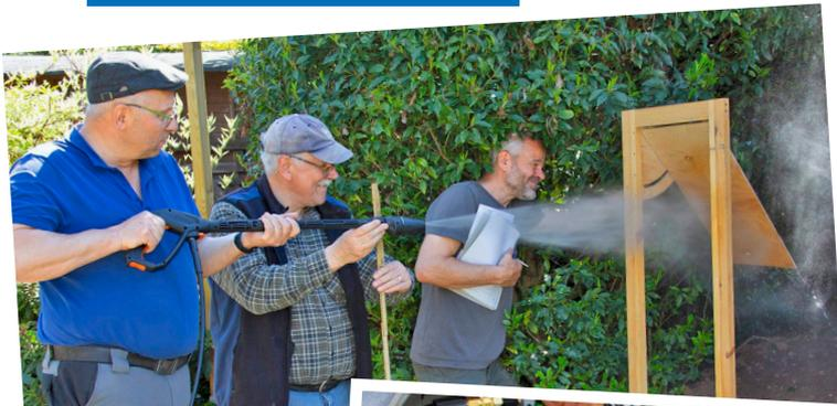
**DIE PENDELPLATTE:** Zeigt die Auswirkung des Wasserstrahldrucks durch den Winkel ihrer Ablenkung an. Je weiter die Platte ausschlägt, desto effizienter ist die Druckwirkung.
