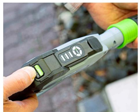
**+ TOP:** Bei *Ego Power+* kann der Druck auch an der Lanze verstellt werden.
