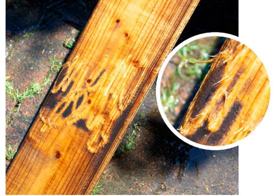
**- HOLZFRÄSE:** Falsche oder falsch eingestellte Vario-Düsen zerstören das Holz.
