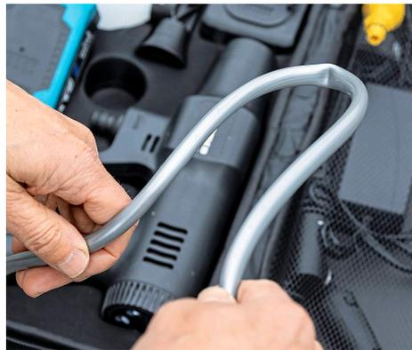
**- KNICKSCHLAUCH:** Der Ansaugschlauch bei *Huhomco* ist zwar lang, aber instabil.
